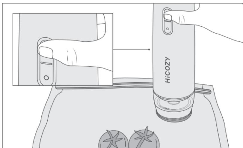
3. Per interrompere il processo di sottovuoto è sufficiente premere il pulsante "Off" . Il processo di sottovuoto si fermerà. Per riprendere il processo di sottovuoto, premere nuovamente il pulsante "On" . Una volta che nel sacchetto è stata estratta sufficiente aria, il dispositivo si fermerà automaticamente.
