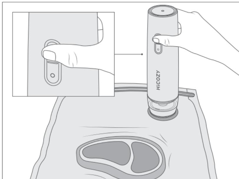
3. Per interrompere il processo di sottovuoto è sufficiente premere il pulsante "Off". Ciò fermerà il processo di sottovuoto. Per riprendere il funzionamento, premere nuovamente il pulsante "On". Una volta completati il processo di sottovuoto e lo svuotamento dei liquidi il dispositivo si fermerà automaticamente.
