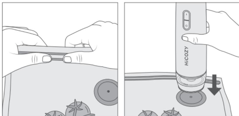
2. Appuyez sur le bouton « I » et maintenez-le enfoncé pendant 2 secondes pour mettre l'appareil en marche ; l'appareil commence à aspirer l'air du sac.
