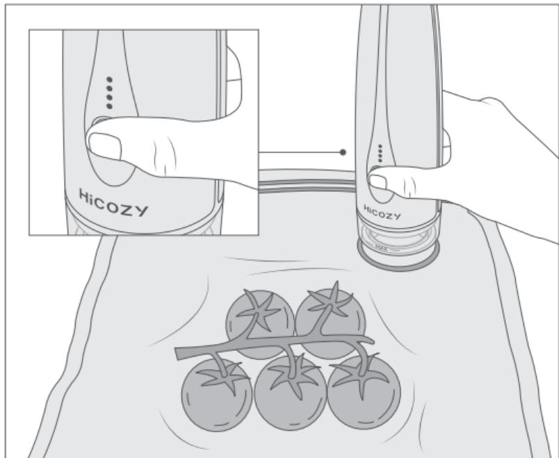
4. 吸引操作が完了したら、自動的に停止します。それと同時に、運転ボタンのインジケーターが点滅して操作が完了したことを知らせてから動作が停止します。
