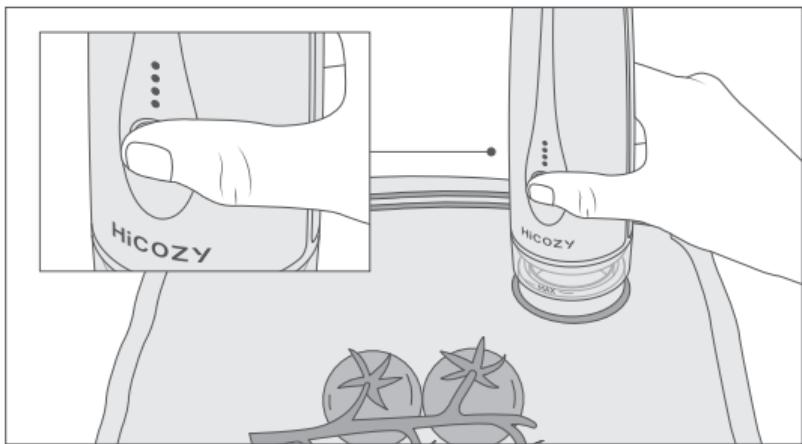
3. 吸引操作を中断する場合、運転ボタンを押します。電源インジケーターが点灯した状態で停止します。運転ボタンをもう一度押すと吸引操作を再開します。
