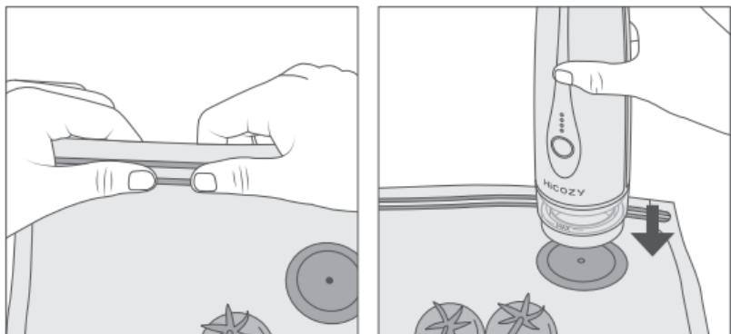
2. Mantenga pulsado el botón durante 2 segundos para encender la máquina, los indicadores de encendido y el botón de funcionamiento se iluminarán y la máquina empezará a aspirar el aire de la bolsa.
