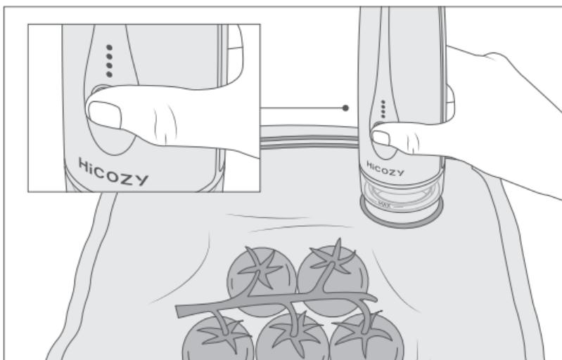
4. Una vez finalizado el proceso de aspiración, éste cesará automáticamente. Al mismo tiempo, el indicador del botón de funcionamiento parpadeará antes de apagarse para indicar que ha finalizado.
