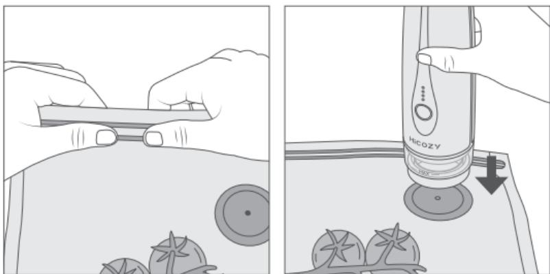
2. ボタンを2秒押し続けて本製品の電源をオンにします。電源インジケーターと運転ボタンが点灯し、空気の吸引動作を開始し
