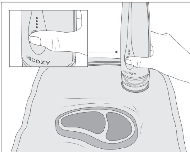
3. Sobald das Behältnis vollständig vakuumiert und die Flüssigkeit entzogen ist, stellt das Gerät automatisch den Betrieb ein.
