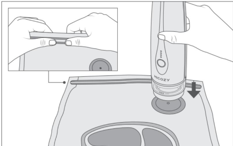
2. Halten Sie die Taste 2 Sekunden lang gedrückt, um das Gerät einzuschalten. Die Akkuanzeigen und die Funktionstaste leuchten daraufhin auf und das Gerät beginnt damit, die Luft und Flüssigkeit aus dem Beutel zu saugen.
