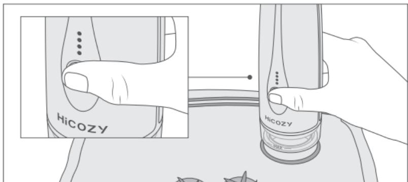
3. Para interrumpir el proceso de aspiración, basta con pulsar el botón de funcionamiento. El aspirado se detendrá con todos los indicadores de encendido iluminados. Para reanudar el trabajo, pulse de nuevo el botón de funcionamiento.
