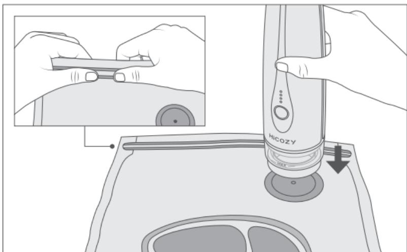
2. Premere e tenere premuto il pulsante per 2 secondi per accendere il dispositivo. Gli indicatori di alimentazione e di funzionamento si accenderanno, e il dispositivo inizierà a fare il vuoto e a risucchiare il liquido.
