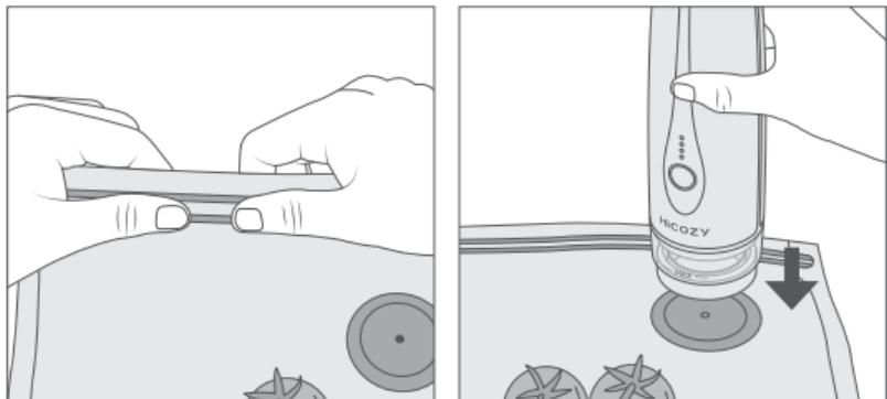
2. Appuyez sur le bouton pendant 2 secondes pour allumer l'appareil, les voyants d'alimentation et le bouton de fonctionnement s'allument et l'appareil commence à aspirer l'air contenu dans le sac.
