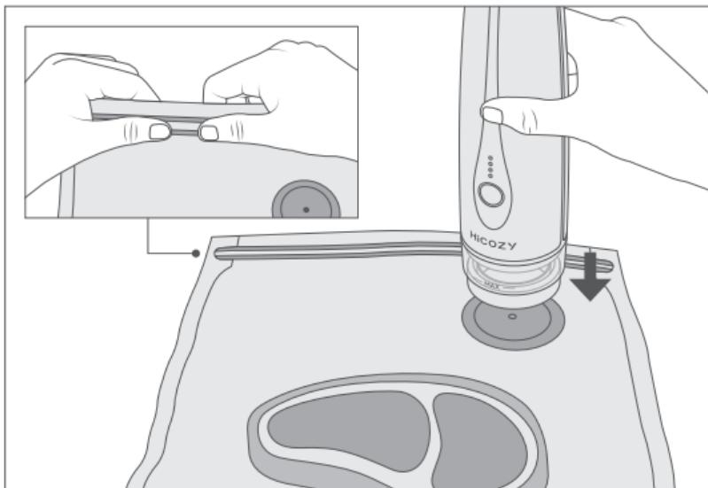
2. Appuyez sur le bouton pendant 2 secondes pour mettre l'appareil en marche. Les voyants d'alimentation et le bouton de fonctionnement s'allument et l'appareil commence à aspirer et à évacuer l'eau.
