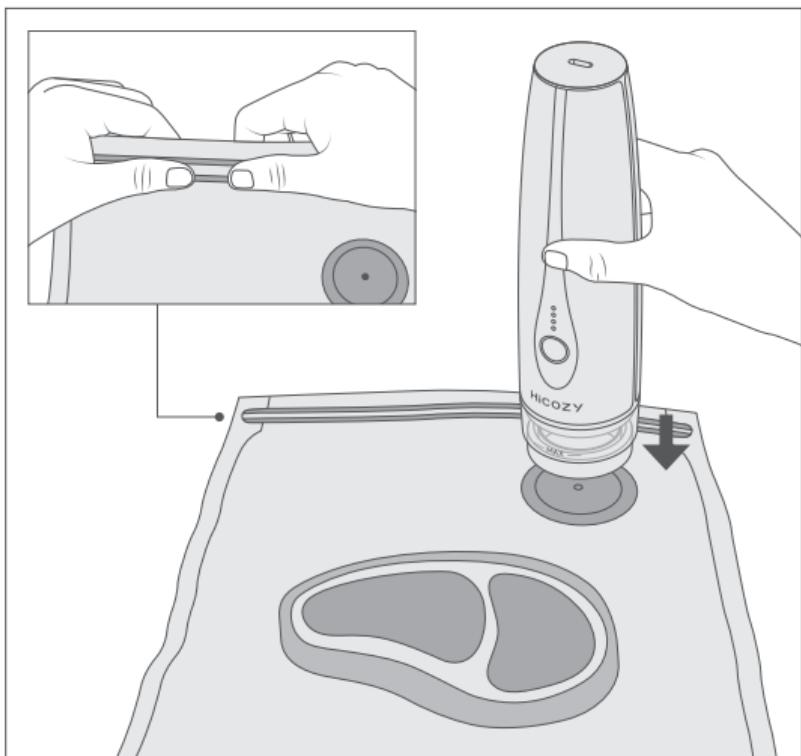
2. ボタンを2秒押し続けて本製品の電源をオンにします。電源インジケーターと運転ボタンが点灯し、空気と水分の吸引動作を開始します。
