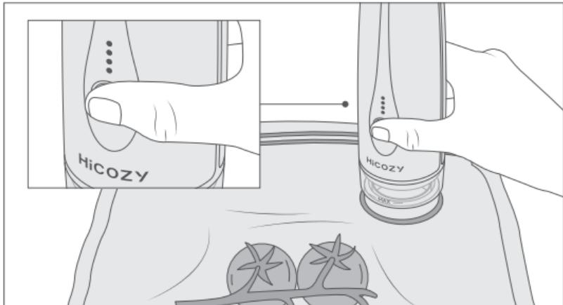
4. Le processus d'aspiration s'arrête automatiquement une fois qu'il est terminé. En même temps, l'indicateur du bouton de fonctionnement clignote pour signaler la fin de l'opération avant de s'éteindre.
