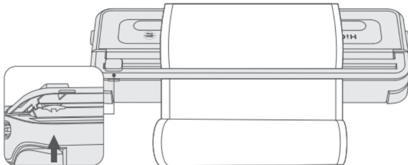
**Paso 3:** Coloque un extremo del material de la bolsa cortada en la banda de sellado y cierre la tapa superior. Presione hacia abajo hasta que encaje completamente.
