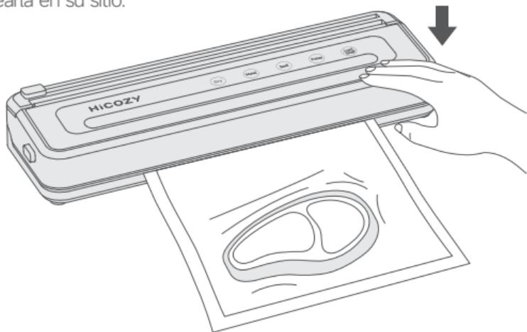
**Paso 5:** Pulse el botón «Vacuum/Seal» (Vacio/Sellado). La unidad vaciará y sellará automáticamente la bolsa.
