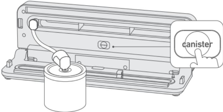
**Paso 5:** Retire la manguera de la tapa del envase y de la selladora al vacío inmediatamente después del sellado.
