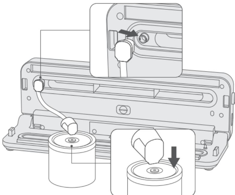
**Paso 4:** Presione el botón «Envase» para comenzar el proceso de vacío. Para un mejor sellado, presione suavemente la tapa del envase al inicio del ciclo. La máquina se detendrá automáticamente una vez que se alcance la presión de vacío deseada.
