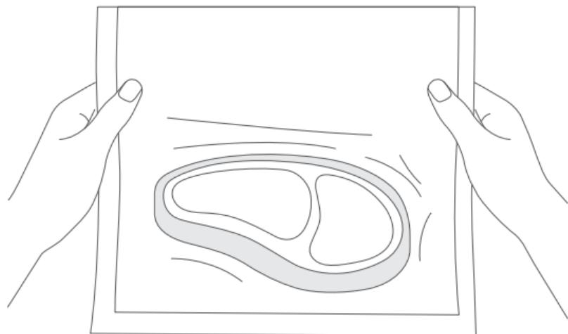
**Paso 3:** Coloque el extremo abierto de la bolsa sobre la cámara de vacío. Asegúrese de que la bolsa no bloquee la entrada de aire.
