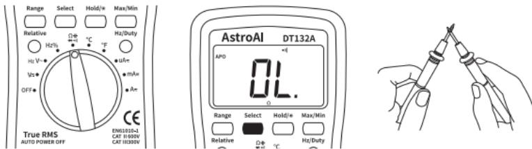
・機能の選択：測定する電圧に応じて、ファンクションスイッチを「V~」または「V=」に合わせてください。
